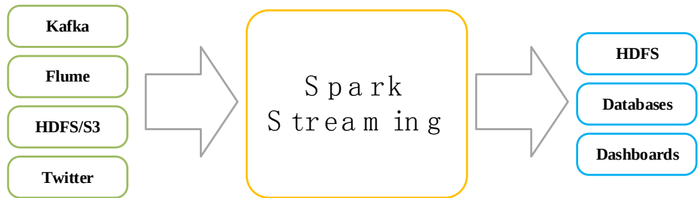
图 3-14 Spark Streaming 数据流处理模式
