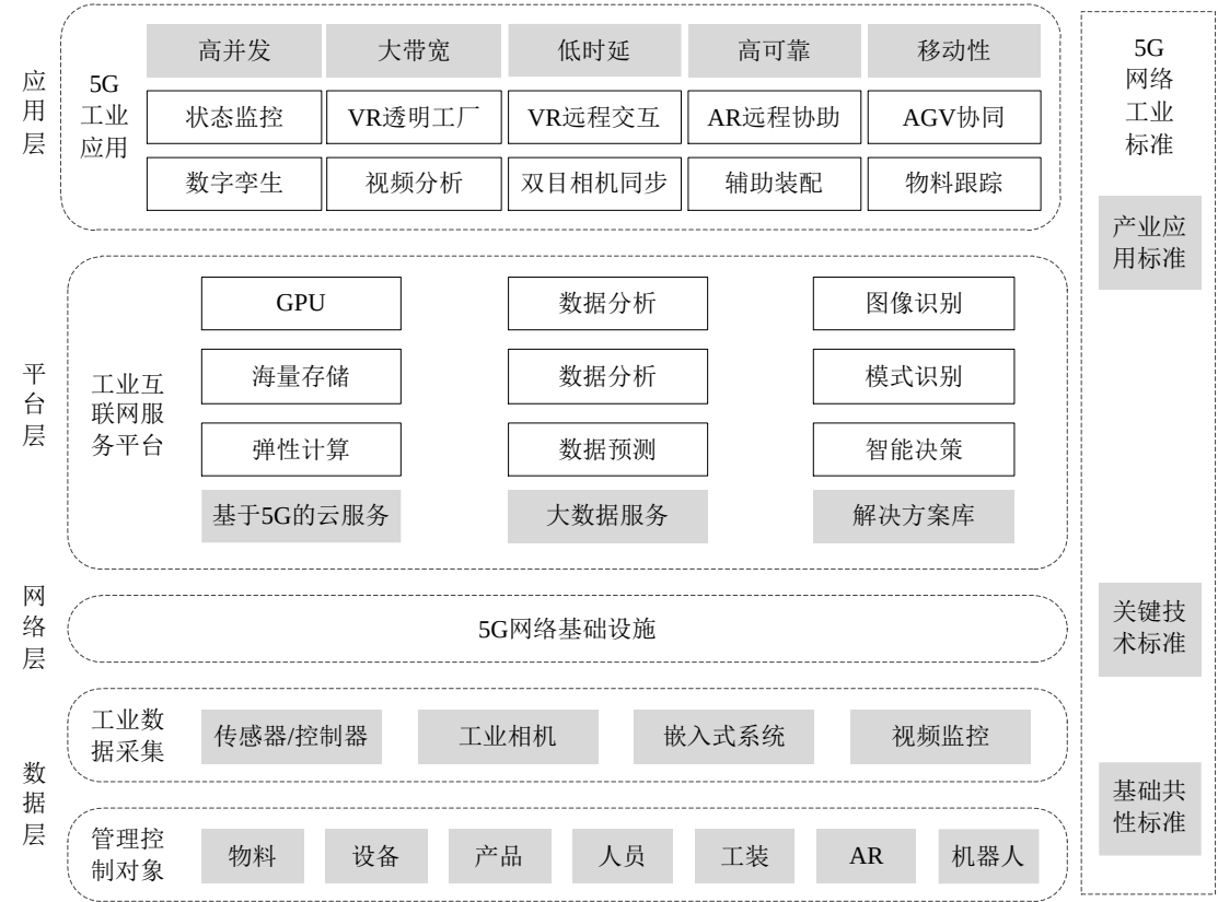
图 6-9 5G+智能制造总体架构
