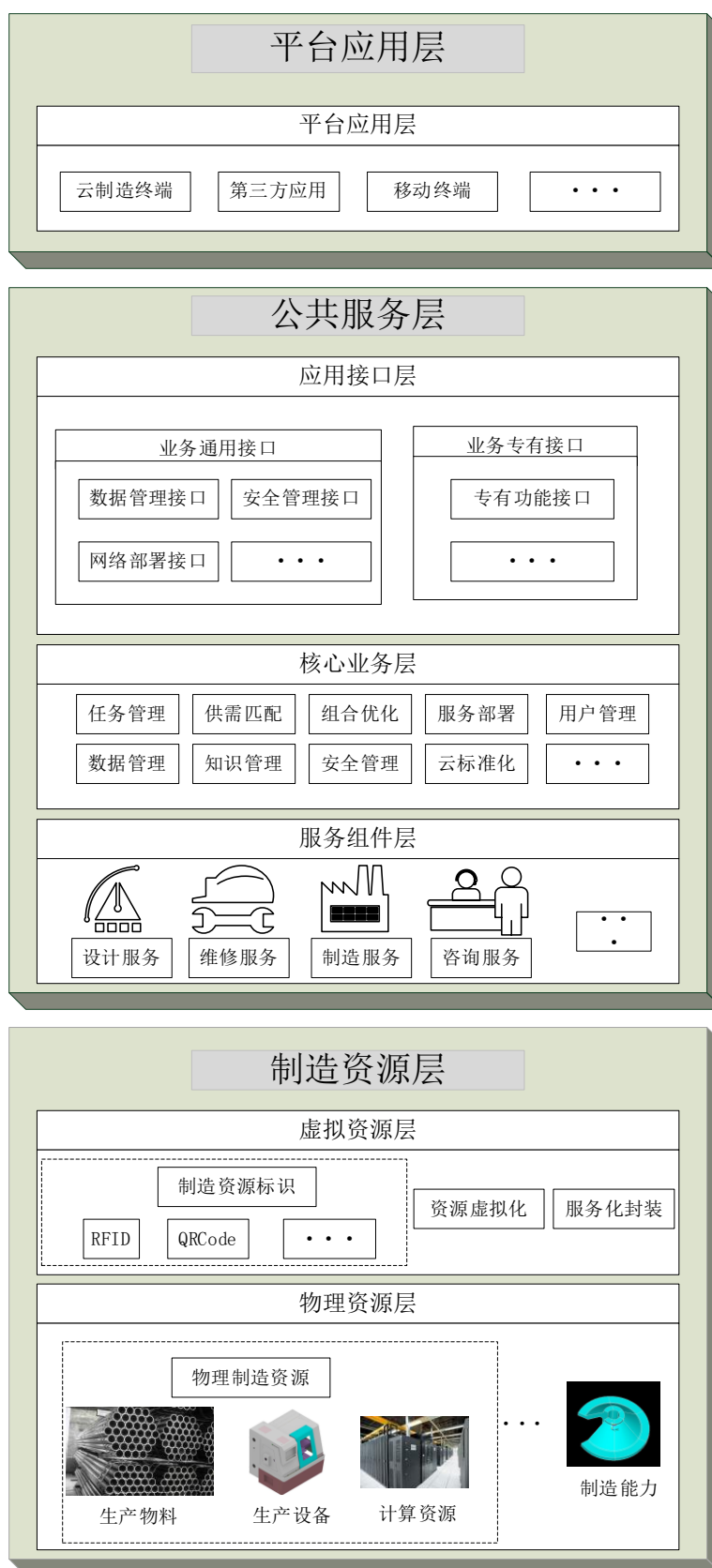
图 4-8 云制造体系架构
