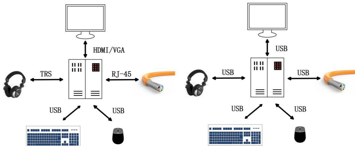
图 11-3 计算机外部接口示意图
